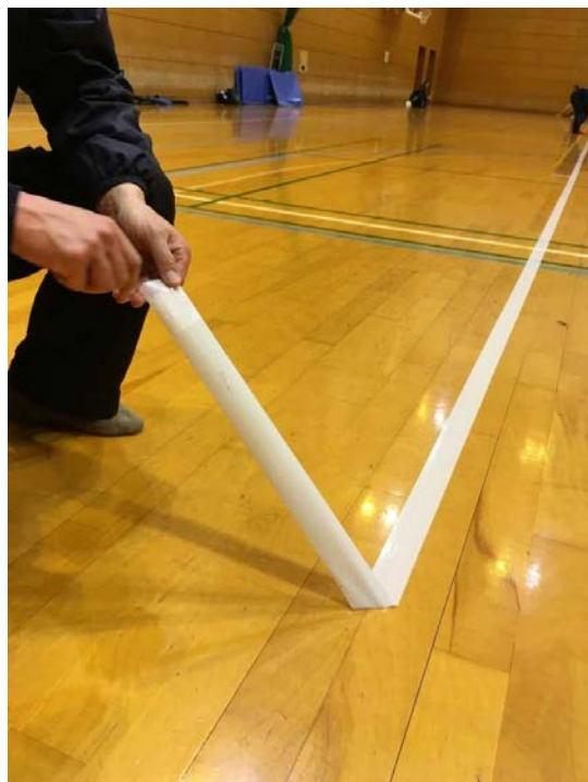
ラインテープの剥がし方の例（斜めにゆっくりと！）
